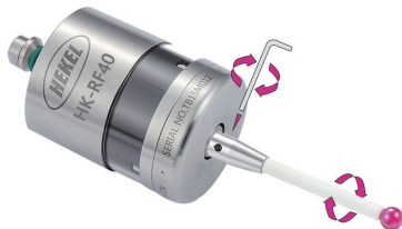
第二步:用1.5mm内六角扳手拧紧测针
